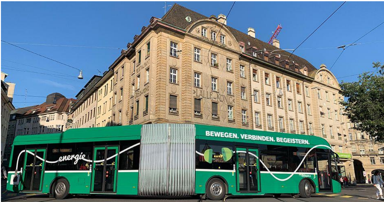
Abb. 9: Erster Elektro-Gelenkbus (VDL Citea SLFA-E 181) der BVB für den Pilotbetrieb, im Linienbetrieb seit dem 8. Februar 2019
